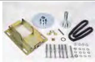
II Kit renvoi d'applications désaxé R. 1:1,5 comprend : Plaque de fixation du motoréducteur comprenant le système de réglage de tension à chaîne. Pignon Z20 avec arbre pour installation sur le motoréducteur. Pignon Z30 avec arbre pour installation sur l'arbre de la porte sectionnelle. Chaîne de renvoi.
