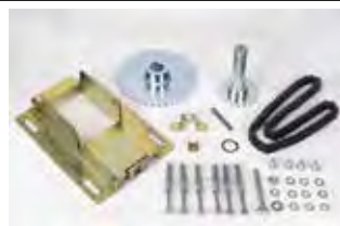
II Kit renvoi d'applications désaxé R. 1:2,0 comprend : Plaque de fixation du motoréducteur comprenant le système de réglage de tension à chaîne. Pignon Z20 avec arbre pour installation sur le motoréducteur. Pignon Z40 avec arbre pour installation sur l'arbre de la porte sectionnelle. Chaîne de renvoi.
