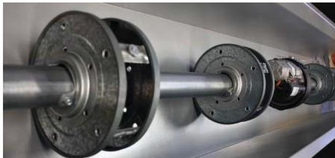
DÉTAIL DE L'APPLICATION DU MOTEUR DANS L'AXE ET LES POLIES
